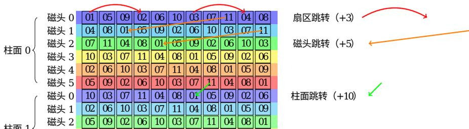
上图中假设有3个柱面，每个柱面6个磁头，每个磁道内11个扇区，并且画出了三种不同的扇区编号跳转情况，分别是磁道内的扇区跳转 (+3)，柱面内的磁头跳转 (+5)，以及柱面间跳转 (+10)。实际磁盘上的柱面数、扇区数要多很多，寻址时需要跳转的距离也可能更长，这里只是举例说明。图中和实际情况相同的是，柱面号和磁头号从 0 开始编号，而扇区号从 1 开始编号，所以做逻辑地址换算的时候要考虑编号差异。
