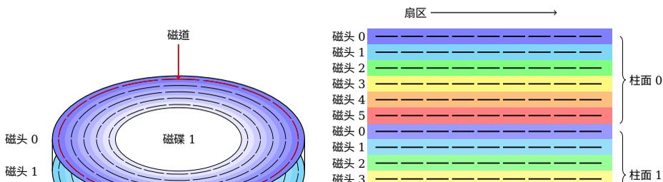
上图中值得注意的是磁道的编号方式，我用相同的颜色画出了相同的磁道。因为按照 CHS 的顺序寻址，所以先定位柱面，然后选定磁头。磁盘上按半径从外向内定义柱面的编号，最外圈的磁道位于 0 号柱面，由 0 号磁头开始。随着柱面编号增加，逐步从外圈定位到内圈。
