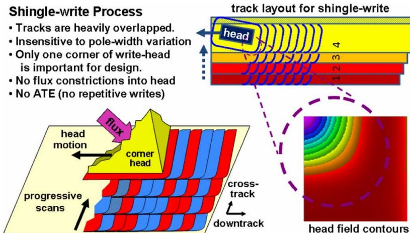
不过技术革新中也有影响寻址方式的技术，比如叠瓦磁记录技术（Shingled Magnetic Recording, SMR）。SMR 技术基于一个技术事实：物理上磁头的写入头（write head）需要比读取头(read head)占用更大面
