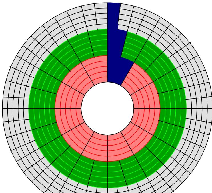
不过随着硬盘容量增加，盘面的数据密度也随之增加，单位面积中理论能容纳的二进制位数量有限。理论上，如果保持相同密度的话，盘片外圈能比内圈容纳更多数据。因此硬盘厂商们开始在盘面上将磁道划分出区块 (zone)，外圈区块中的磁道可以比内圈区块中的磁
