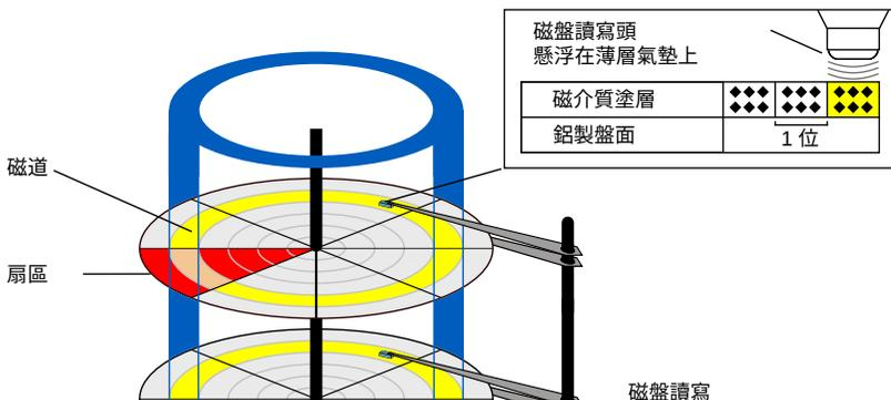
如右图所示，一块硬盘(Hard Disk Drive, HDD)是一个圆柱体转轴上套着一些磁碟片(platter)，然后有一条磁头臂(actuator arm)插入磁碟片间的位置，加上一组控制芯片(controller)。每个磁碟片有上下两面涂有磁性材质，磁头臂上有一组磁头(head)，每个磁头对应磁盘的一个面，所以比如一个3碟的硬盘会有6个磁头。
