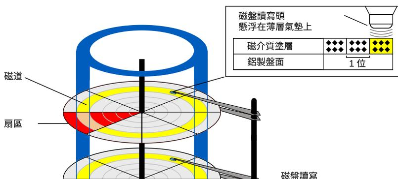
如右圖所示，一塊硬盤(Hard Disk Drive, HDD)是一個圓柱體轉軸上套着一些磁碟片(platter)，然後有一條磁頭臂(actuator arm)插入磁碟片間的位置，加上一組控制芯片(controller)。每個磁碟片有上下兩面塗有磁性材質，磁頭臂上有一組磁頭(head)，每個磁頭對應磁盤的一個面，所以比如一個3碟的硬盤會有6個磁頭。
