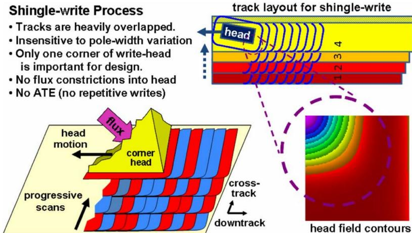
不過技術革新中也有影響尋址方式的技術，比如疊瓦磁記錄技術（Shingled Magnetic Recording, SMR）。SMR 技術基於一個技術事實：物理上磁頭的寫入頭（write head）需要比讀取頭(read head)佔用更大面
