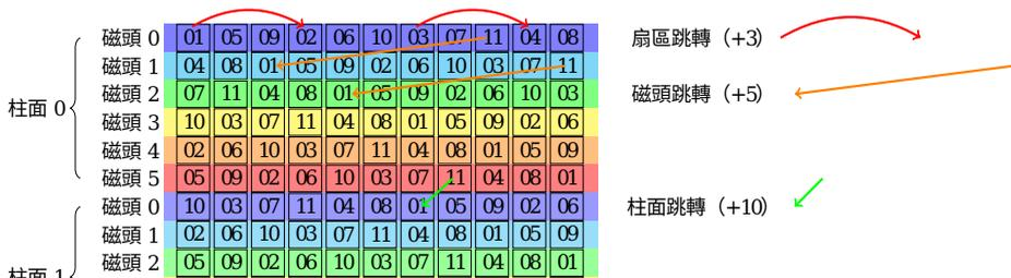
上圖中假設有3個柱面，每個柱面6個磁頭，每個磁道內11個扇區，並且畫出了三種不同的扇區編號跳轉情況，分別是磁道內的扇區跳轉 (+3)，柱面內的磁頭跳轉 (+5)，以及柱面間跳轉 (+10)。實際磁盤上的柱面數、扇區數要多很多，尋址時需要跳轉的距離也可能更長，這裏只是舉例說明。圖中和實際情況相同的是，柱面號和磁頭號從 0 開始編號，而扇區號從 1 開始編號，所以做邏輯地址換算的時候要考慮編號差異。
