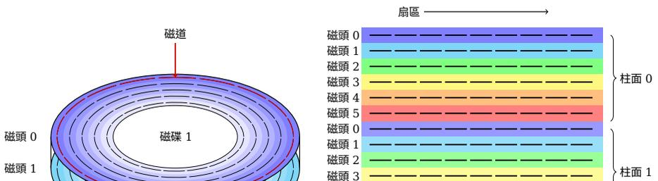
上圖中值得注意的是磁道的編號方式，我用相同的顏色畫出了相同的磁道。因為按照 CHS 的順序尋址，所以先定位柱面，然後選定磁頭。磁盤上按半徑從外向內定義柱面的編號，最外圈的磁道位於 0 號柱面，由 0 號磁頭開始。隨着柱面編號增加，逐步從外圈定位到內圈。
